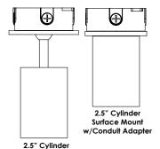
Slope Pendant w/Surface Mount **Conduit Adapter**
